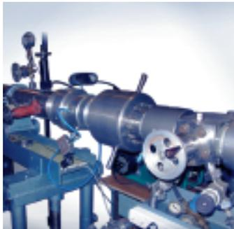
Бездиафрагменные ударные трубы для исследования высокоскоростных потоков. Обеспечивают проведение экспериментов с высокой производительностью и повторяемостью.
